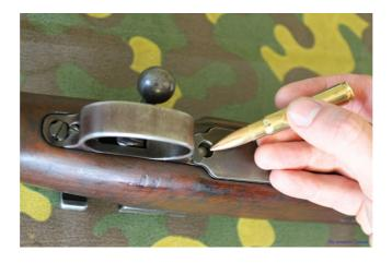
Il caricamento, come la maggior parte dei bolt-action dell'epoca, può avvenire sia tramite lastrine in maniera veloce inserendole nell'apposita feritoia a "U" sia una alla volta.
