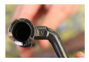
Lo smontaggio è estremamente semplice... se si conosce il trucco! A cosa serve l'anello d'acciaio nel calcio... ebbene si! Serve per disassemblare, dall'otturatore, il percussore al suo interno senza difficoltà e soprattutto senza attrezzi ma solo con le nude mani!
