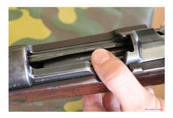
Il serbatoio da cinque colpi a presentazione bifilare può essere rimosso per manutenzione o per uno scaricamento rapido premendo il tasto nel foro presente alla base della soletta con l'ogiva di una cartuccia.
