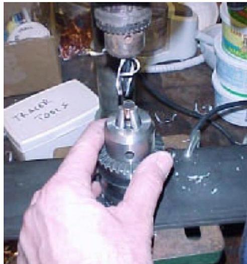
Centrate perfettamente i centri dei due mandrini, uniteli con una astina metallica inserita in essi, poi bloccate il mandrino inferiore, sistemate tutto in modo che il foro nei proiettili non sia più lungo dei 3/5 della lunghezza totale, sistemate un fermo in modo che il proiettile da forare non possa scivolare in basso nel mandrino basso. Questo sistema permette di forare con precisione e 100 proiettili in solo 15’.
