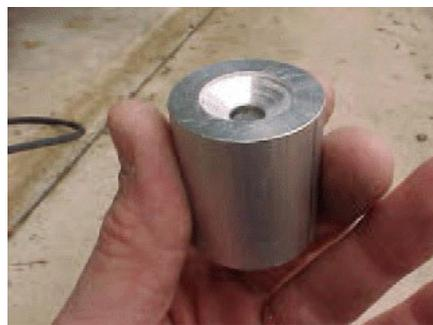
Fondete un buon numero di pallottole e poi trafilatele in modo che siano pronte per essere caricate. Per provare se il DIE che avete costruito funzionano, introducete un proiettile in essi, con un perno e un martello pressateli ripetutamente al suo interno quindi estraete i proiettili. Se esso non si è deformato il DIE è di ottima fattura. Non è facile fare un buon DIE per questo conviene farne diversi prima di averne uno veramente ottimo.
