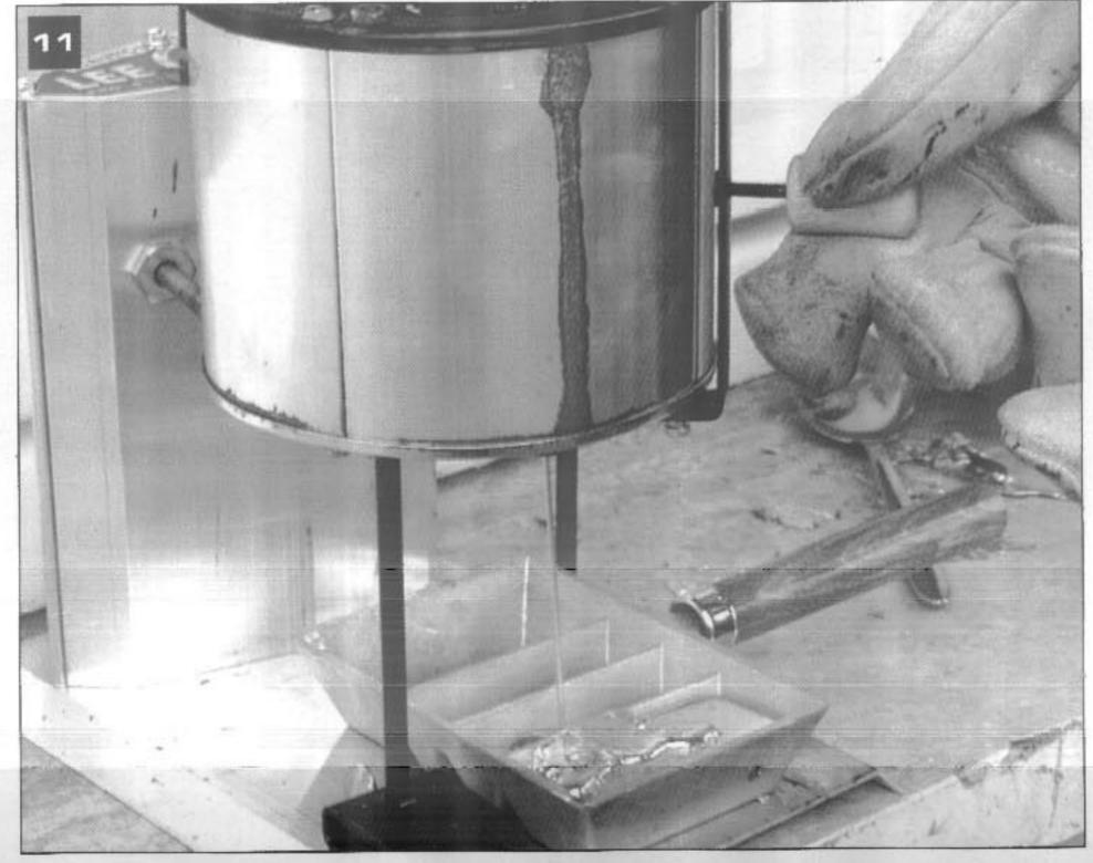
Prima di colare i lingotti, sarà necessario regolare il reostato della fornace, che avevamo aperto al massimo. Il reostato porta alcuni numeri, che sono puramente indicativi. Infatti la regolazione ottimale dipende da molti fattori, come la composizione della lega e la temperatura esterna. Si tratterà di ruotare il lingotto fino a trovare la temperatura appena sufficiente a mantenere liquida la
