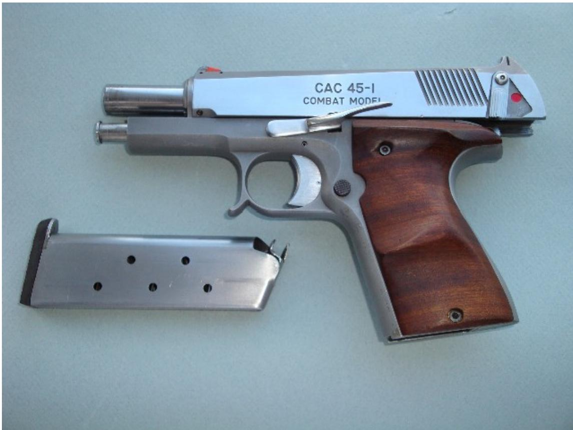
L'arma é completamente realizzata in acciaio inossidabile, il fusto ha un aspetto che rammenta la microfusione, mentre il carrello é manifestamente ricavato da un unico pezzo fresato.
