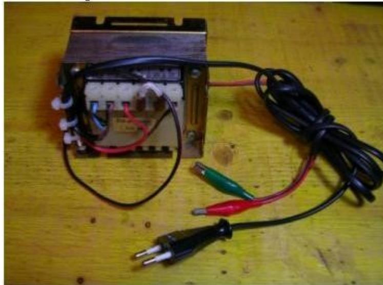
Certamente è abbondante per lo scopo ma funziona molto bene. Diciamo che è possibile usare un trasformatore da **18 Volt** per una resistenza da **47 Ohm** mentre per un trasformatore da **15 Volt** servirà una resistenza da **39 Ohm** oppure da **33 Ohm** se il trasformatore sarà da **12 Volt**.
