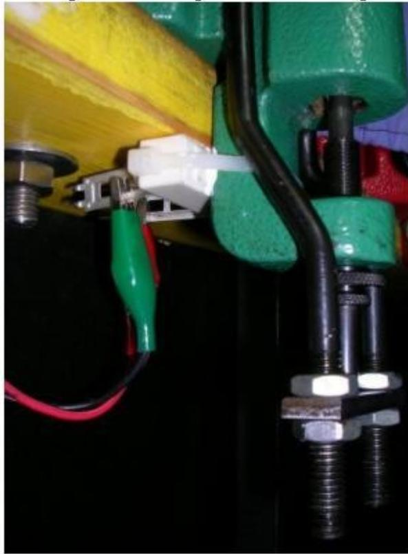
Un'ultima cosa: non crediate di accendere il riscaldatore e di iniziare a trafilare, anche perché se così fosse significherebbe che la temperatura erogata sarebbe così alta da liquefare il grasso e questo non va bene, diciamo che potremmo iniziare a lavorare con la trafilatrice dopo 30-40 minuti dall'accensione.
