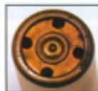
la parte posteriore della munizione con l'innesco centrale e i quattro fori di propulsione
