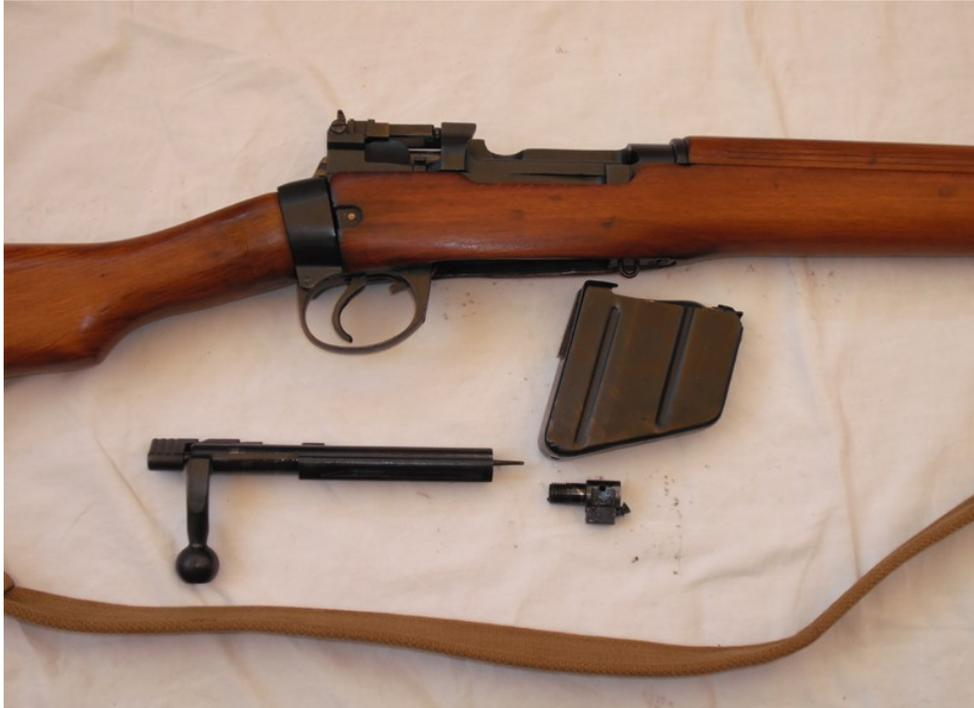
**Smontaggio da campagna. L'otturatore è rimosso tramite un pulsante sul lato destro di culatta insieme alla sua testina a vite e al caricatore in lamiera, svincolato tramite una leva sulla guardia del grilletto, per una normale pulizia non è richiesto di più. Semplice e razionale per un militare al campo. Ben più complicato è uno smontaggio completo specie dell'otturatore e in questo i sistemi Mauser sono meglio.**
