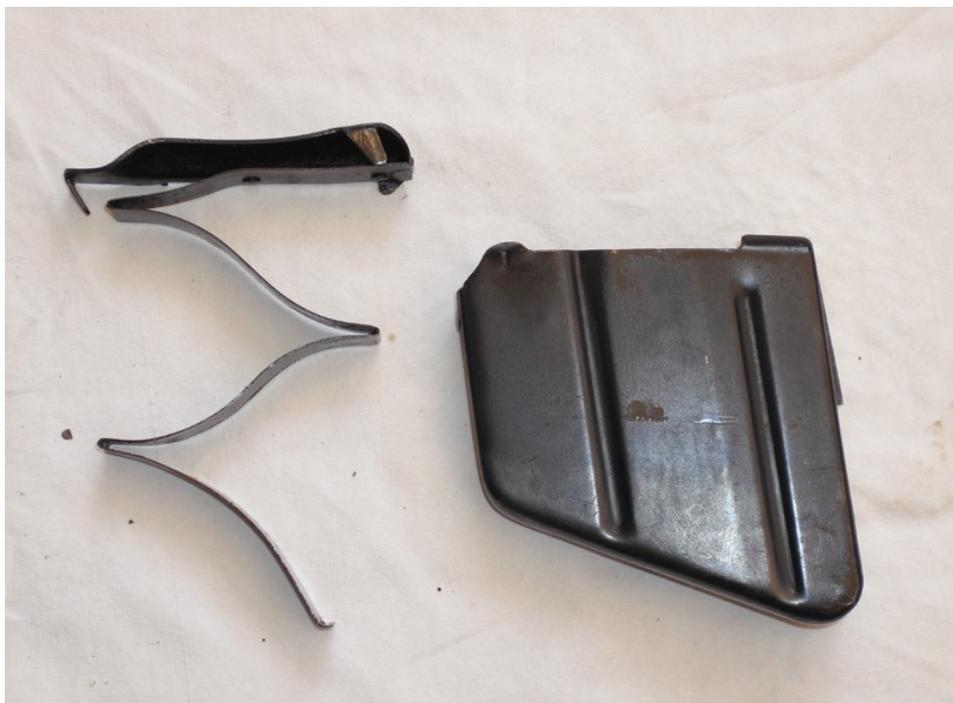
Il caricatore è amovibile per la manutenzione ma veniva lasciato in loco e riempito con due lastrine da 5 colpi trattenute da uno scasso sulla culatta, è realizzato in lamiera di buona robustezza, la particolare sagomatura è dovuta alla munizione rimmed ( con collarino) impiegata.
