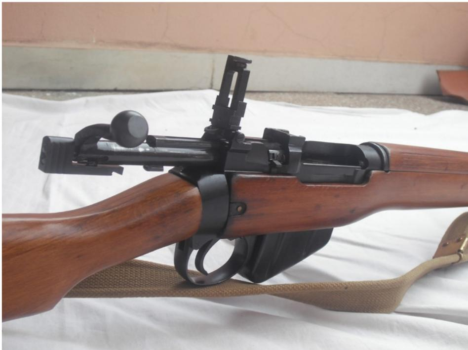
**Vista superiore otturatore aperto e diottra alzata con alzo regolabile tra 100 e 1300 yarde con incrementi di 25 le diottrre saranno anche prodotte in lamiera, senza vite di regolazione ma con un cursore e a "L" con due fori uno per le 300 e l'altro per le 600 yarde. Per semplificazione di produzione in piena guerra il foro di alleggerimento sul pomello non è stato realizzato , pur previsto nella zona piana**
