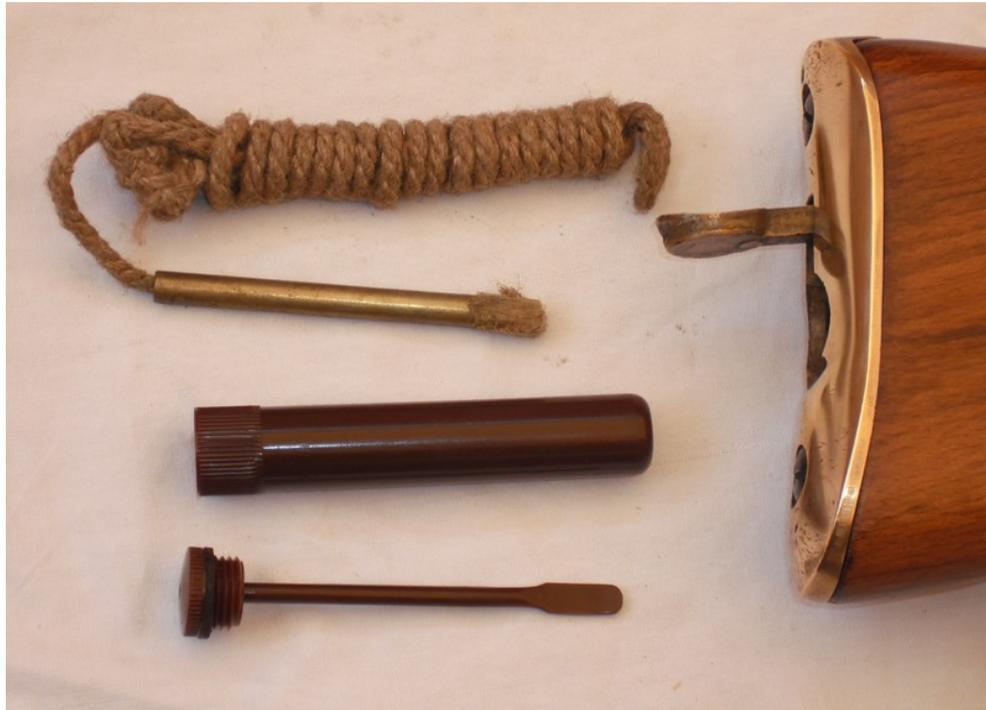
Questo è il kit di pulizia contenuto all'interno del vano. Un oliatore realizzato in plastica e uno spago su cui montare una speciale garza metallica e/o una pezzuola alla sua estremità. Insufficiente per una buona pulizia ma perfetto per le esigenze campali di manutenzione ovviamente non ne consiglio l'uso ma storicamente è buona cosa riempire un vano vuoto.
