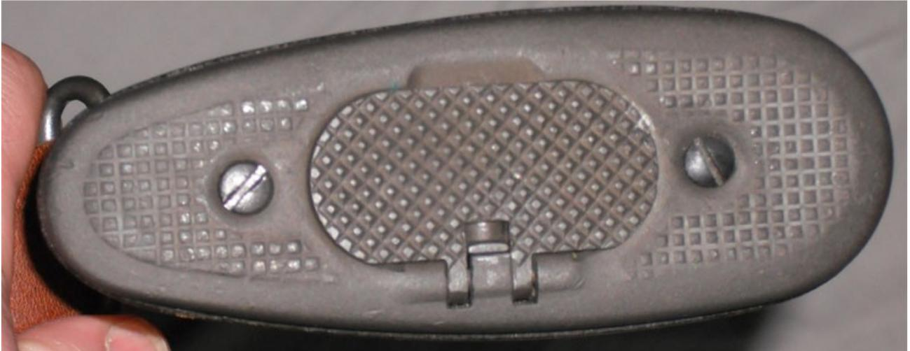
IL CALCIO DEL GARAND VENNE PROTETTO DA UN ROBUSTO CALCIOLO IN ACCIAIO MUNITO A SUA VOLTA DI COPERCHIO CHE DAVA ACCESSO A DUE VANI, RICAVATI NEL LEGNO, PER CONTENERE UN KIT DI PULIZIA 'CAMPALE'. LA SUPERFICIE ESTERNA DEL CALCIOLO ERA ZIGRINATA PER CONSENTIRE UNA PIU SOLIDA PRESA SULLA SPALLA RISPETTO A UNO LISCIO.
