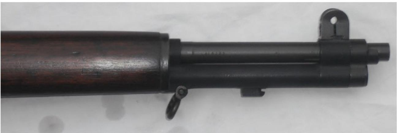
IL SISTEMA A PRESA DI GAS VISTO MONTATO, L'ASPETTO
