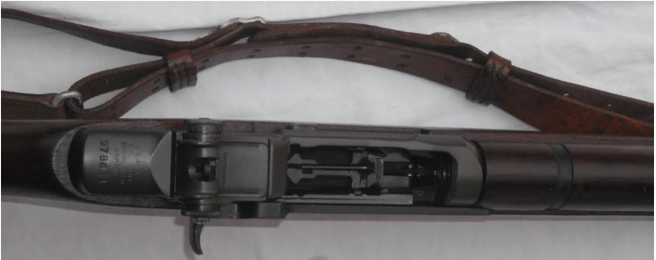
L'OTTURATORE È ARRETRATO E PRONTO A RICEVERE IL 'FAMIGERATO' PACCHETTO DA 8 COLPI CALIBRO 30-06. LA MANETTA VA TRATTENUTA DURANTE L'INSERIMENTO E LASCIATA ANDARE CON ATTENZIONE, PENA FERIRE IL POLLICE DESTRO RESPONSABILE DELL'INSERZIONE A PRESSIONE DELLA CLIP. SPARATO L'ULTIMO COLPO VIENE ESPULSA LA CLIP VUOTA E LA BARRA OPERATIVA RIMANE BLOCCATA APERTA ALL'INDIETRO.
