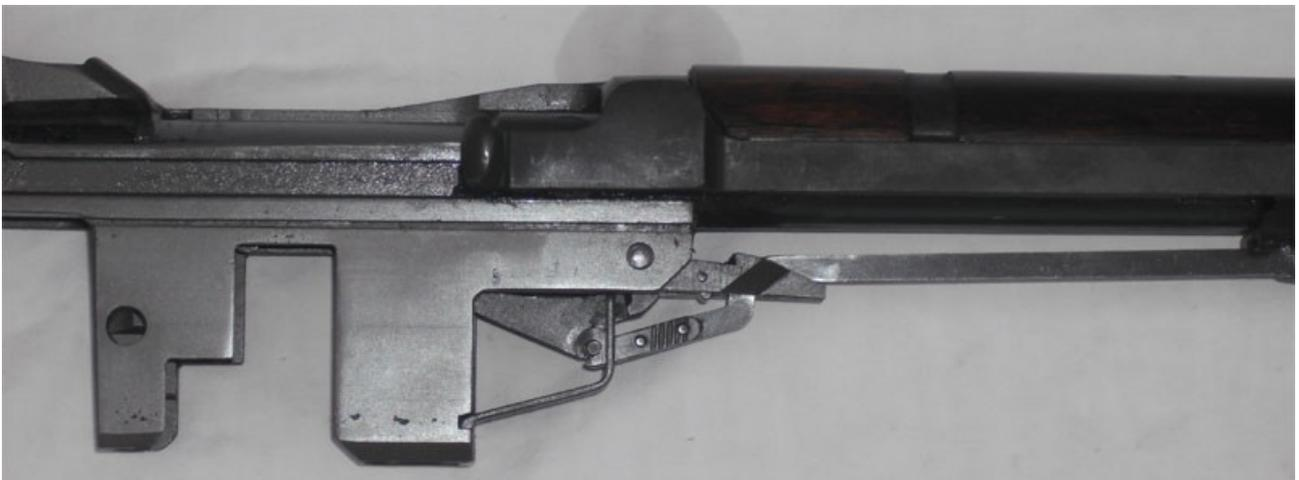
PARTICOLARE DELLA CULATTA, LA FINITURA È ESEGUITA PER FOSFATAZIONE, DETTA PARCHEZZAZIONE, TRAMITE FOSFATI. CONSENTE UNA RESISTENZA SUPERFICIALE ALLA CORROSIONE MOLTO SUPERIORE ALLA BRUNITURA, PUR NON AVENDONE L'ESTETICA; LA SUPERFICIE INOLTRE È RUVIDA E ADATTA A TRATTENERE LUBRIFICANTI PROTETTIVI.
