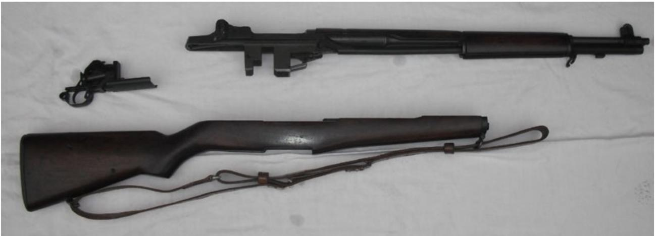
IL GARAND SMONTATO NEI SUOI TRE SUBINSIEMI, IL PACCHETTO DI SCATTO TRAMITE LA ROTAZIONE DELLA GUARDIA PERMETTE IL BLOCCAGGIO DEL GRUPPO, NON APPARE UNA SOLUZIONE PARTICOLARMENTE SOLIDA MA LO È PER VIA DELL'OTTIMA QUALITÀ DEL NOCE IMPIEGATO. L'USO PROTRATTO NEL TEMPO TUTTAVIA FA INSORGERE GIOCHI COL LEGNO CHE INFICIANO LA PRECISIONE DELL'ARMA DIVENENDO IL GRUPPO 'BALLERINO'. A CIÒ SI PONE RIMEDIO 'BEDDINGANDO' NEI PUNTI DI PRESSIONE DEL PACCHETTO O SOSTITUENDO IL CALCIO.
