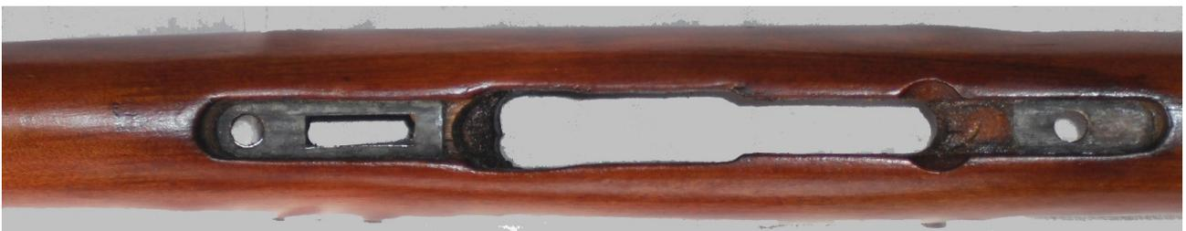
In questa vista inferiore del calcio si notano inserti metallici dove è avvitato il caricatore, l'incassatura della meccanica era particolarmente curata, ciò al fine della precisione del tiro.
