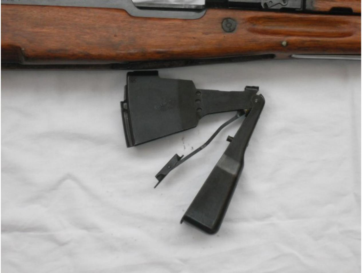
Il magazzino contenente in origine 10 cartucce è realizzato in lamierino sufficientemente robusto con una lunga suola elevatrice, il perno che si vede sporgere dal fondello limita l'abbassamento della suola in modo tale da non permettere il superamento delle 5 cartucce per le allora esigenze di catalogazione. L'insieme è decisamente desueto anche all'epoca della sua adozione e il caricamento avveniva tramite scomode clip da colpi o in mancanza manualmente una alla volta.
