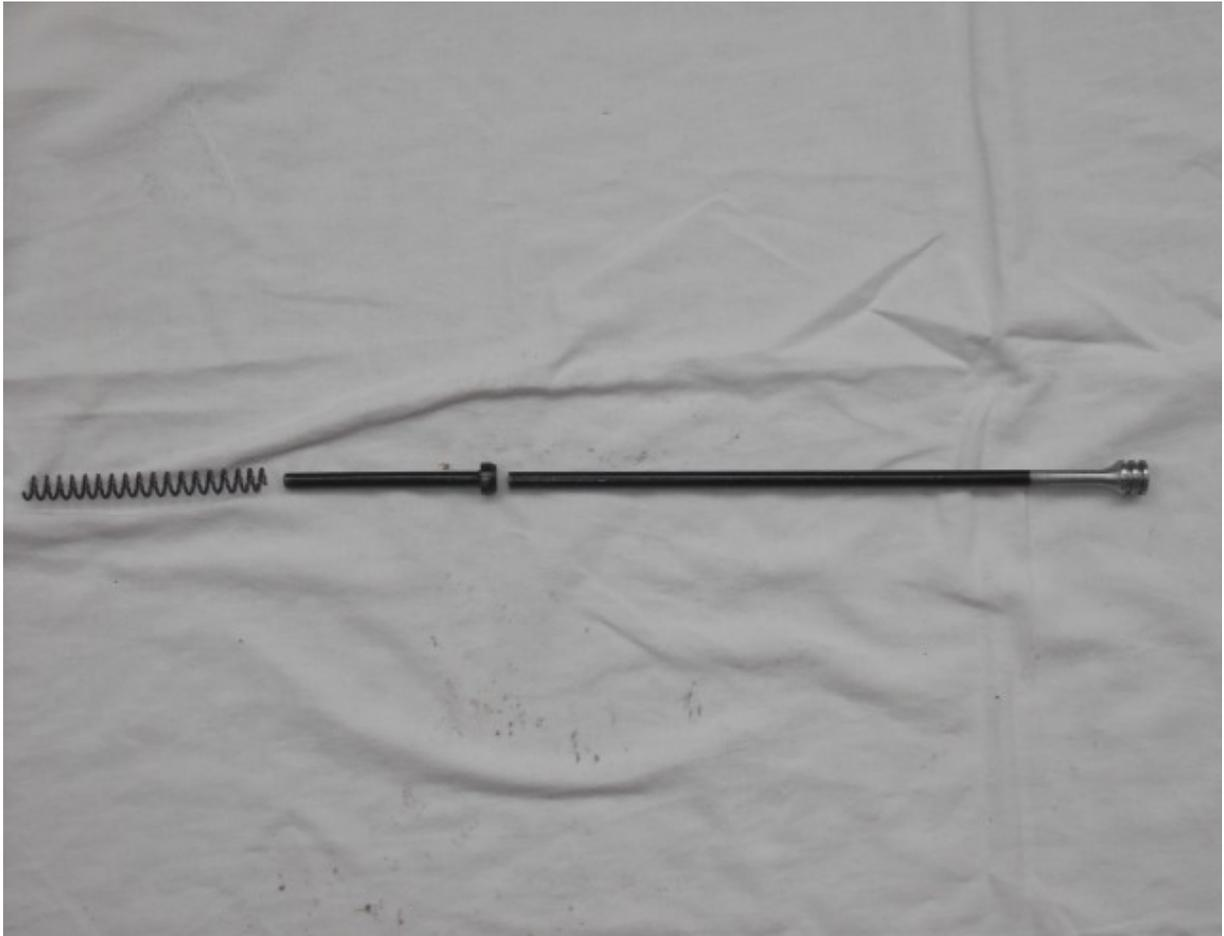
il pistone è realizzato in acciaio , ma la parte a contatto con i gas di combustione spillati è cromata pena la rapida corrosione del medesimo, La sua estensione, caricata da una molla di ritorno che si vede in foto, ha il compito di trasmettere l'energia cinetica al porta otturatore .
