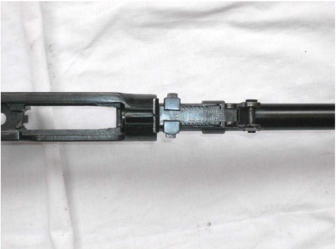
Vista superiore del collegamento culatta/canna , sulla camera di cartuccia è montata la tacca di mira a cursore regolabile da 100 a 1000 metri. La lettera ' D ' prima dell'alzo dei 100 metri indica un alzo da combattimento tarato a 300 metri per
