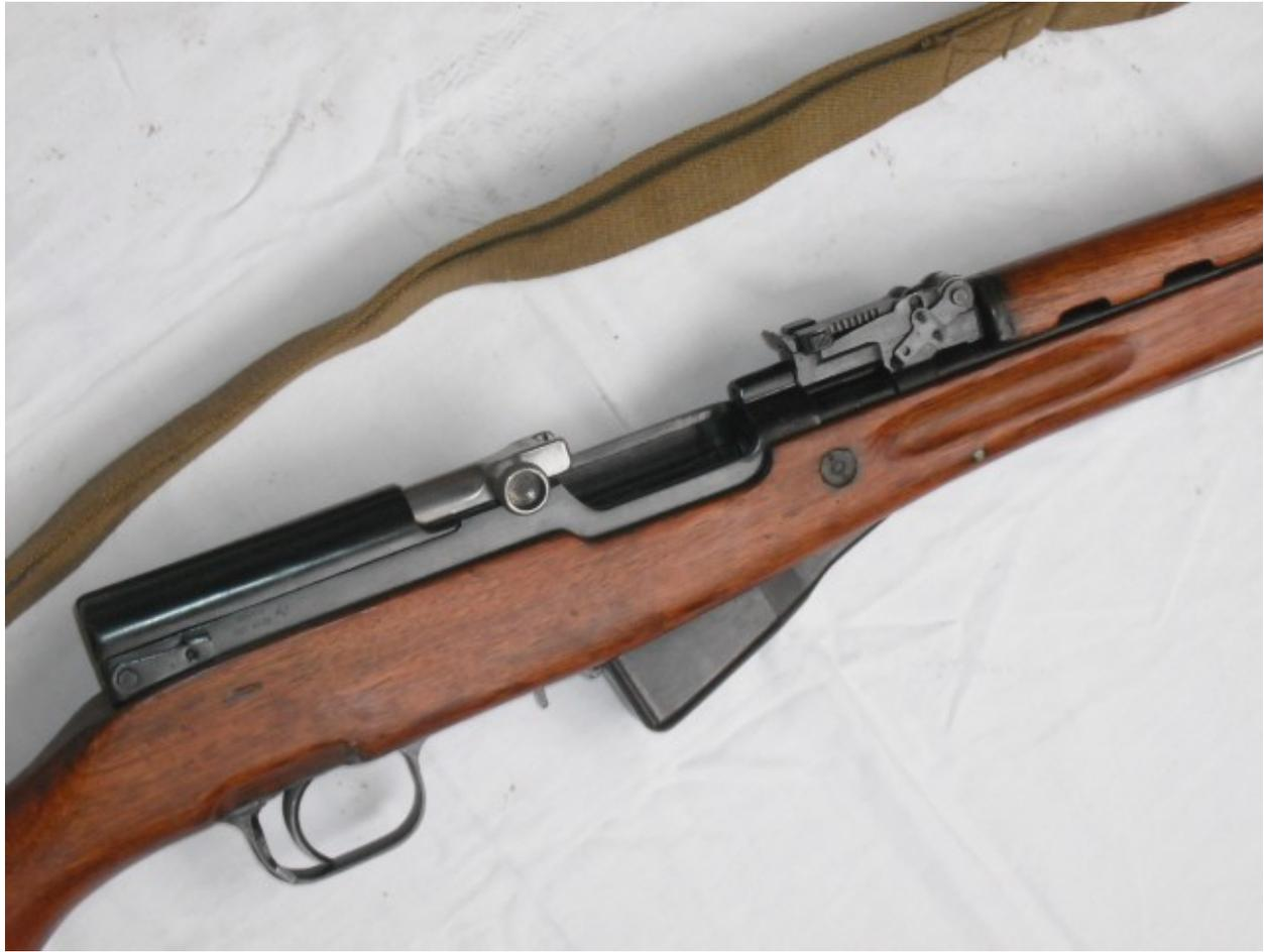
Vista della parte centrale, il porta otturatore è arretrato e bloccato in sito dall'hold open che funge in battaglia da avvisatore di arma scarica, permette quindi l'introduzione della clip, a perdere, da 10 colpi. La tacca di mira è realizzata a cursore, la visibilità è buona ma non possiede una correzione laterale è possibile ovviare all'inconveniente con prodotti after market sulla tacca di mira che la rendono traslabile lateralmente .
