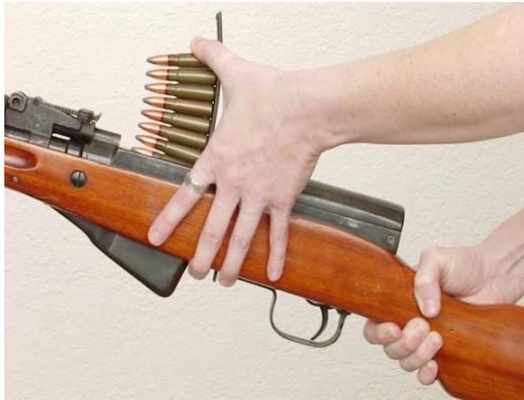
*caricamento tramite clip da 10 colpi*
