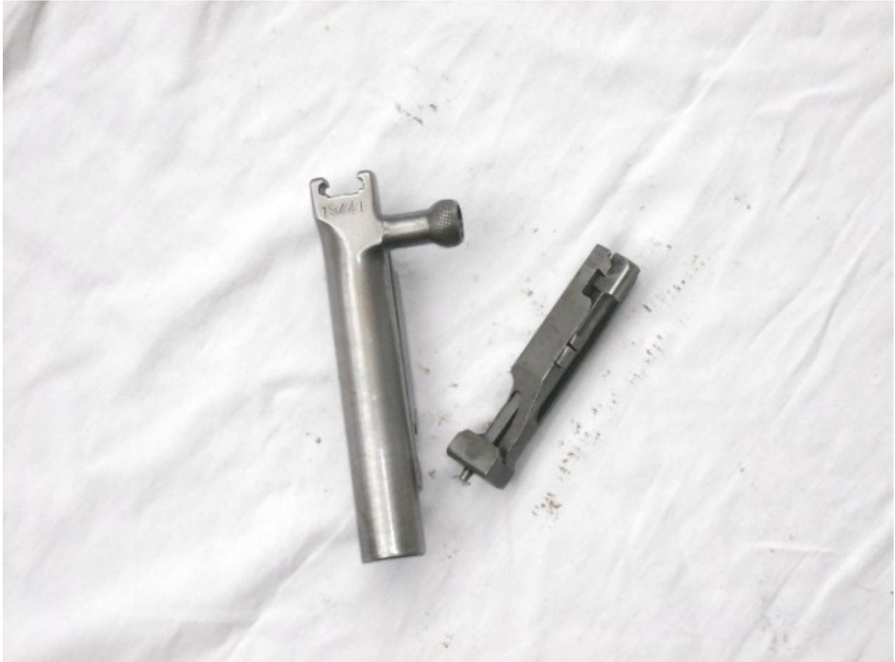
Porta otturatore e otturatore, la manetta di armamento presenta una zigrinatura di presa e una fresatura sulla sommità, vicino al numero di matricola, che permette l'inserimento della clip da 10 colpi a otturatore aperto.
