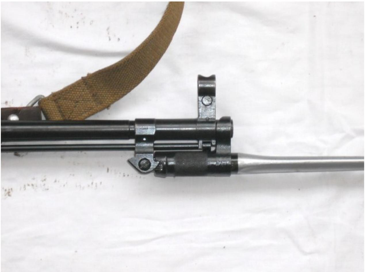
La baionetta è fissata a un supporto della canna tramite una vite, gli esemplari per il mercato civile hanno un rivetto al posto della vite. La lama ruota sino a imboccolarsi sulla volata, tra la baionetta e la canna è presente la bacchetta di pulizia.
