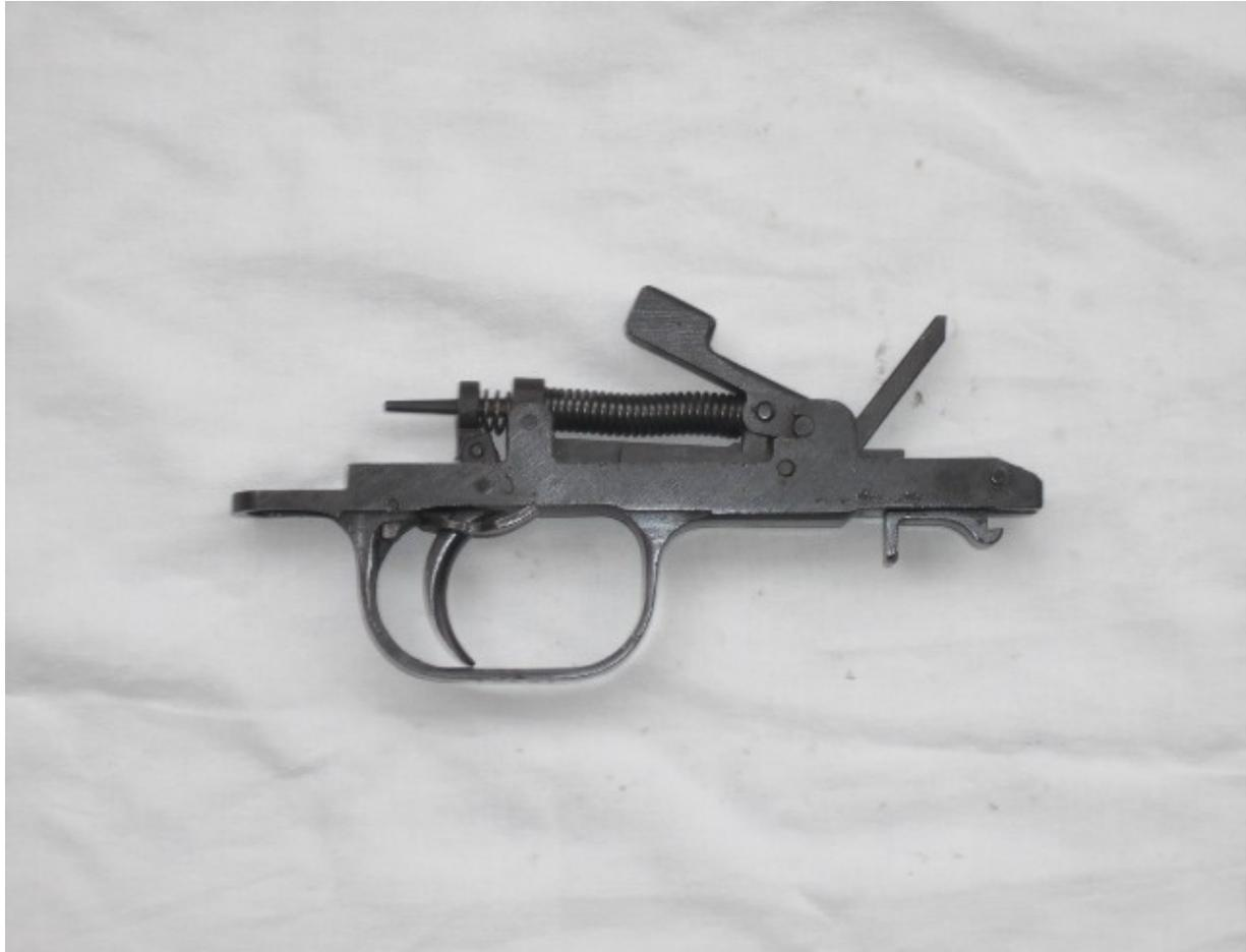
Il pacchetto di scatto mutuato dal Simonov avs36, presenta all'interno, come un po' tutto il fucile, evidenti segni di macchina utensile. È di disegno semplice ma molto efficace, per lo smontaggio dall'arma, tramite un perno dietro la guardia, è tassativo che il cane sia armato e in sicura. La molla che spinge il cane è di forza considerevole.
