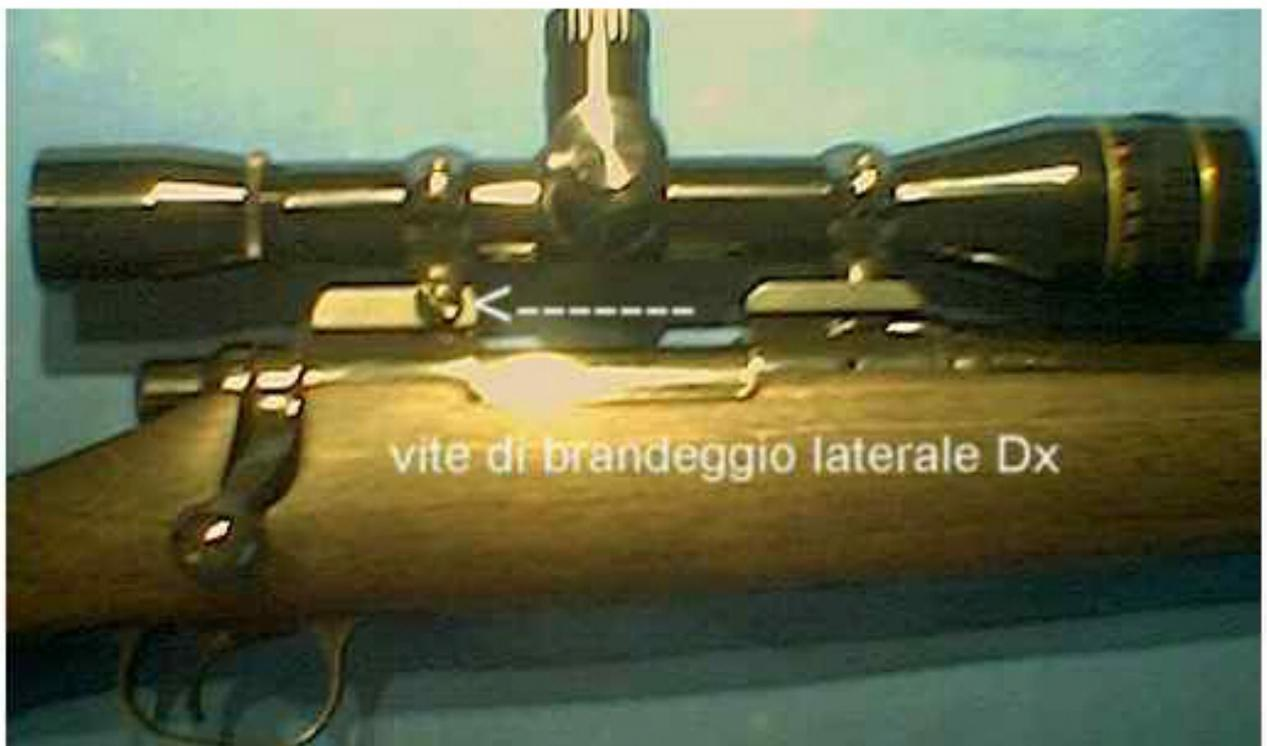
Una volta accertato il giusto montaggio dell'ottica , è buona norma sparare qualche colpo e ricontrollare il fissaggio delle viti , soprattutto quelle delle basette , a questo punto saremo pronti per la taratura vera e propria.
