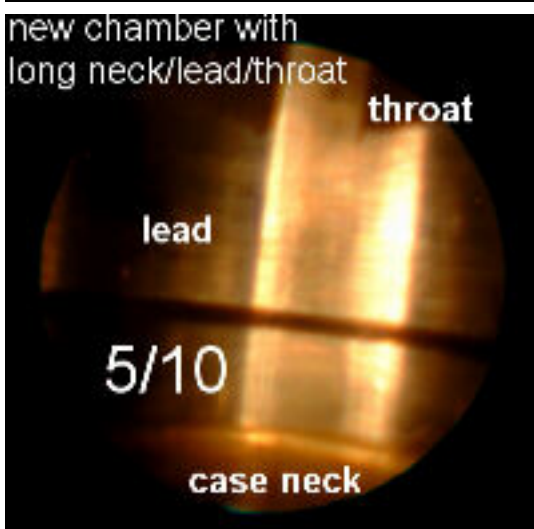
Foto 2) Cameratura nuova con alesatore tradizionale (il bossolo arriva a 5/10 ).
