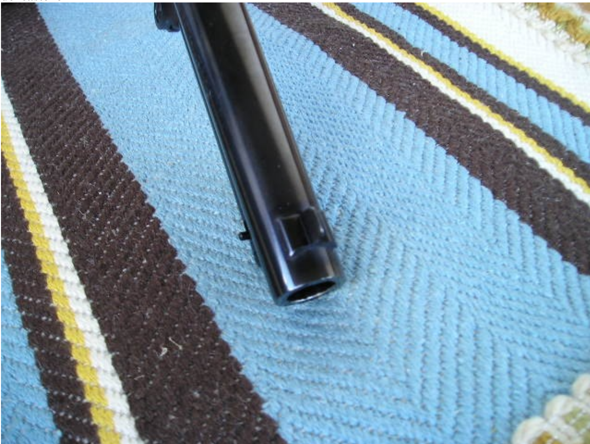
Figura 6: Il mirino, del tipo a lama, è inserito su un inserto a coda di rondine
