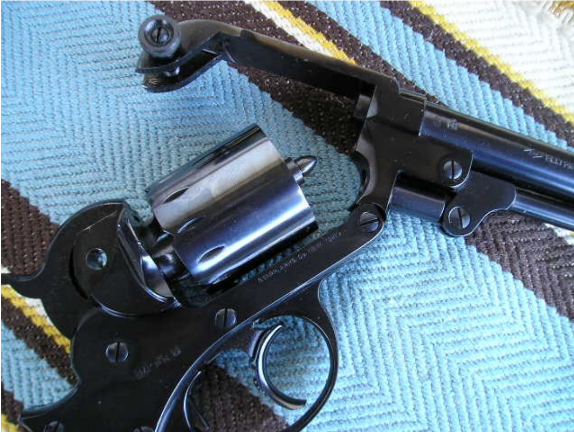
Figura 3: Particolare del sistema di apertura del castello chiamato "top break"
