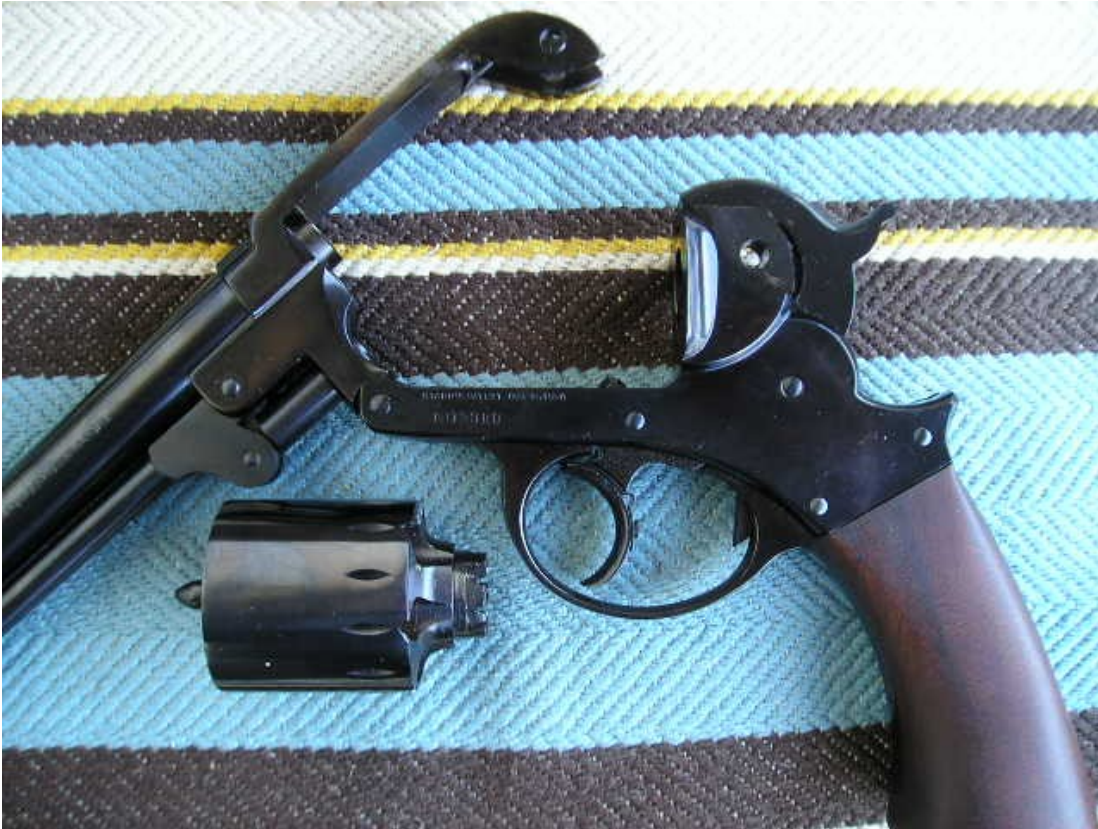
Figura 2: Per aprire il revolver è sufficiente estrarre la spina filettata posta nella parte superiore del castello
