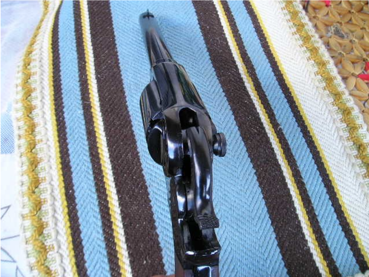
Figura 5: La tacca di mira e ricavata sul paraschegge del cane. Si noti la Spina filettata che permette l'apertura del castello
