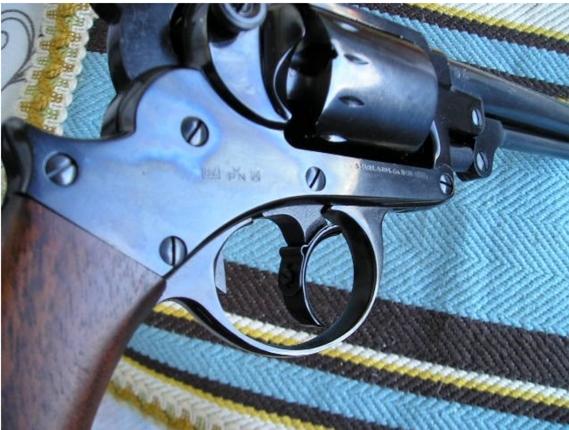
Figura 4: Particolare della molletta posta dietro al grilletto che discrimina la doppia/singola azione
