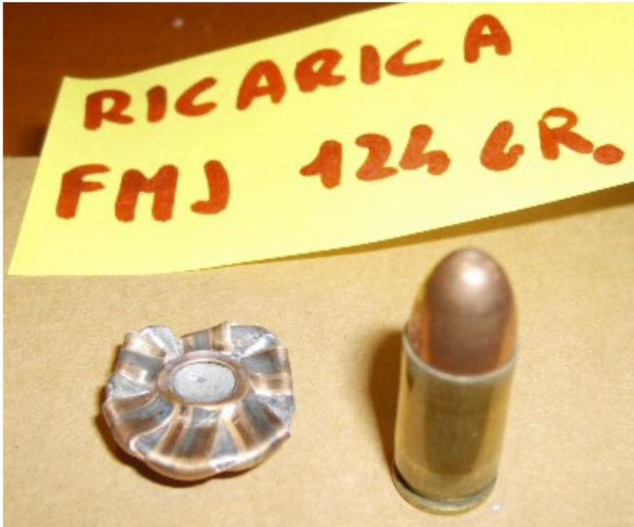
Speer JSP 124 grs.: Anche quest'altra ricarica con palla Speer ha mantenuto fede alla buona qualità dei prodotti di questa nota ditta. La palla JSP si è schiacciata rimanendo anch'essa compatta, misurando infine 23x20 mm. e con uno spessore di 3 mm. circa. Un buon termine di paragone con la palla precedente.
