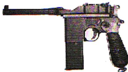
Caratteristiche comune di tutti i modelli della Schnellfeuer era il caricatore amovibile da venti colpi.
