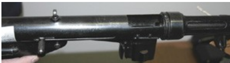
Foto 9: dopo ogni colpo esploso e dopo ogni colpo successivo, l'otturatore rimane aperto ma la leva di armamento rimane chiusa Foto sotto
