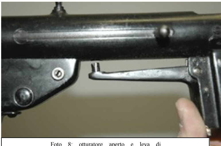
Foto 8: otturatore aperto e leva di armamento retratta, l'arma è pronta al fuoco.
