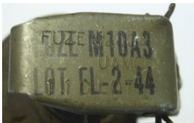
Un'altra particolarità, una spoletta M200A1 convertita in M10A3
