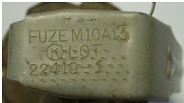
Una spoletta M10A1 convertita in A3
