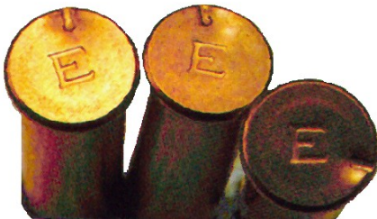
Segni dell'urto del percussore nella zona periferica (anulare) nel fondello delle cartucce cal. .22 L.R.
