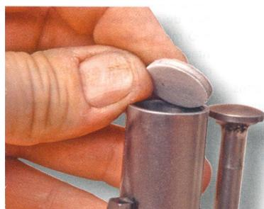
Io uso semplicemente una rondella in cartone di 18 mm di diametro, spessa 3 mm. Una volta che la carica è versata in fondo al tubo, la rondella viene spinta con la bacchetta a testa abbastanza larga per evitare di girare. La palla ricoperta di sego è introdotta allora ed è bloccata sulla rondella per mezzo di due colpi leggeri di bacchetta. Come mostreranno le nostre prove, la rondella va a raschiare la parete del tubo, contribuendo così a limitare il suo incrostamento.
