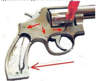
Solo a questo punto. se ve lo lasciano fare. si può procedere allo smontaggio. Per provvedervi, si inizia con il rimuovere le guancette, che sono trattenute da un'unica vite. Α questa operazione segue la rimozione della molla del cane, dopo aver allentato la vite che la carica. La parte più delicata è quella della rimozione della
