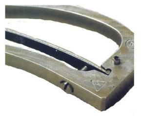
Nel revolver S&W l'unica molla a lamina è quella del cane. Tutte le altre sono state sostituite da molle elicoidali. Le molle a filo garantiscono una maggiore uniformità caratteristiche elastiche. perché partono tutte dallo stesso omogeneo, mentre ogni esemplare di molla a lamina ne presenta di diverse. Ad esempio risentirà sempre delle condizioni di
