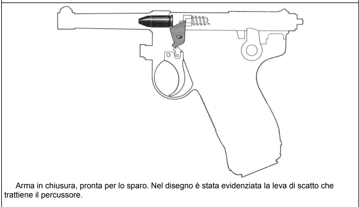
Pistola automatica modello 1910 sezionata.
