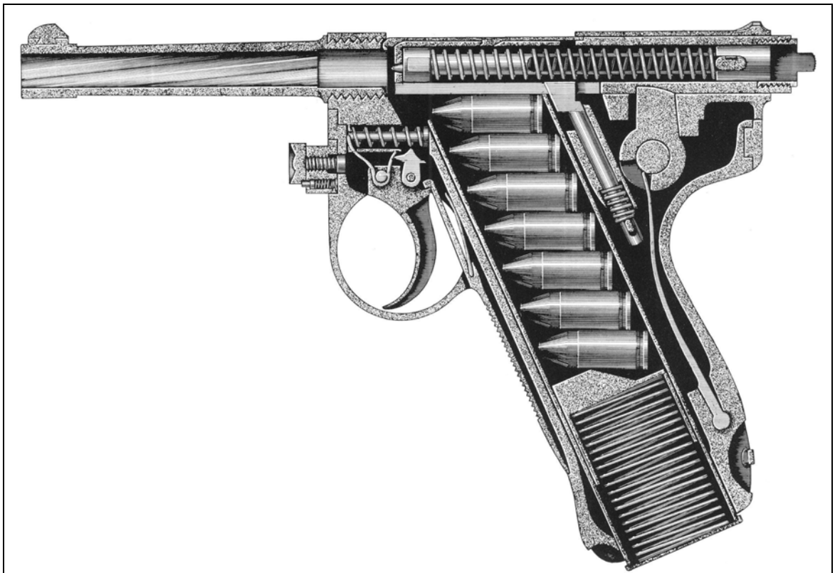
Pistola automatica modello 1910 sezionata.
