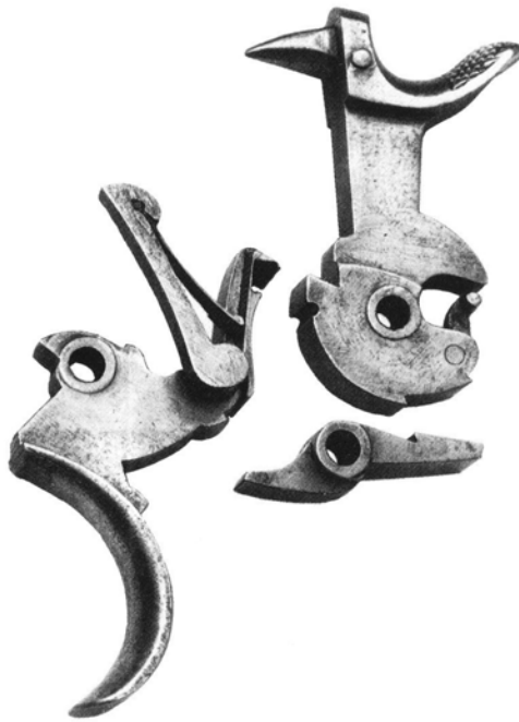
Il cane, lo scatto e il grilletto con impernati il bocciolo e il tirante.
