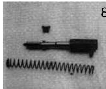
il gruppo del percussore può essere smontato arretrando la molla e sfilando le due valvole della guida.
