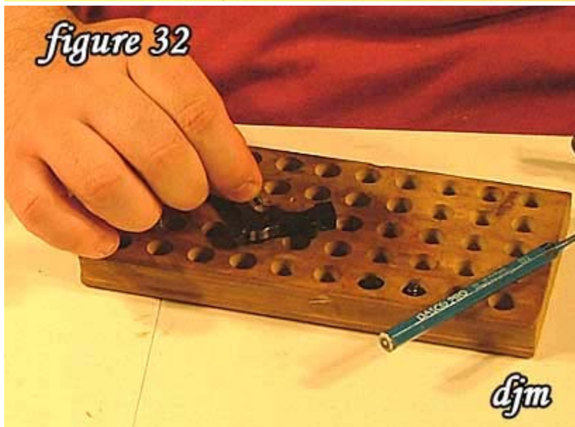
32) Remove the trigger pin.
