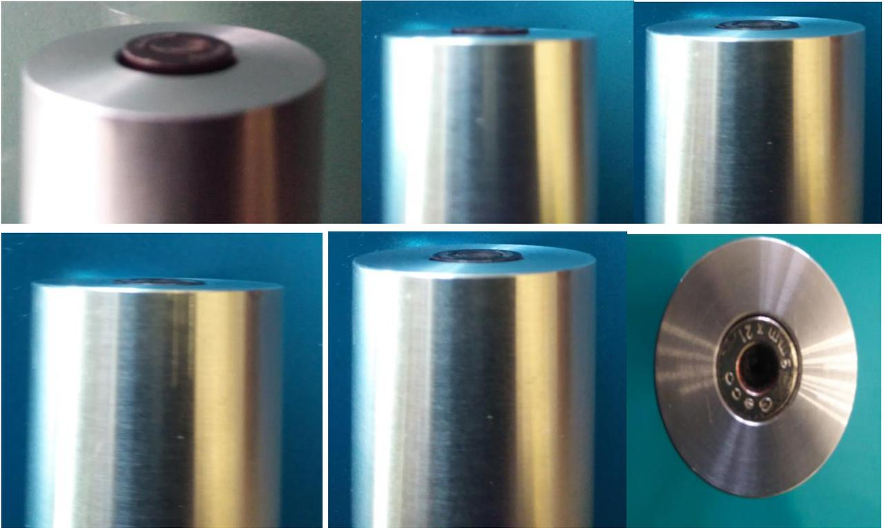
**Inoltre grazie al perno filettato per uno stesso calibro, potremo modificare il settaggio di risconto per adeguarlo a diverse altezze ed ogive.**
