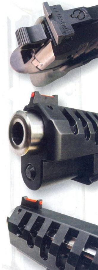
La canna delle pistole Grand Power di cui la parte inferiore è lavorata a forma di smussatura elicoidale, si impenna direttamente sulla carcassa dell'arma. Un sistema innovatore per la sua semplicità e la sua robustezza.
