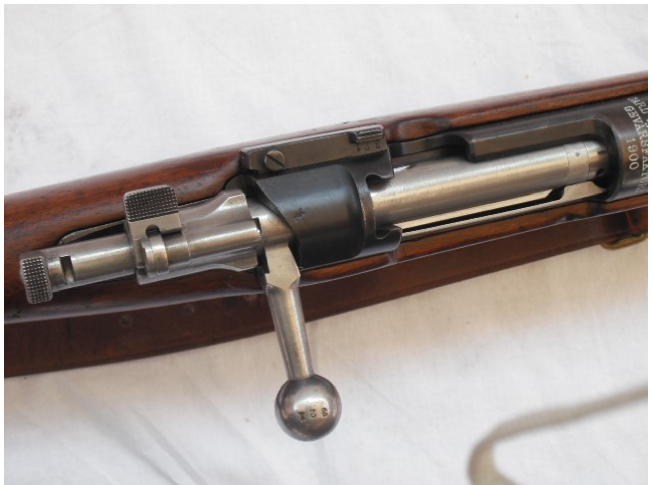
Il tubetto è in posizione armato e la sicura a bandiera è disinserita, il percussore si arma col movimento in chiusura dell'otturatore
