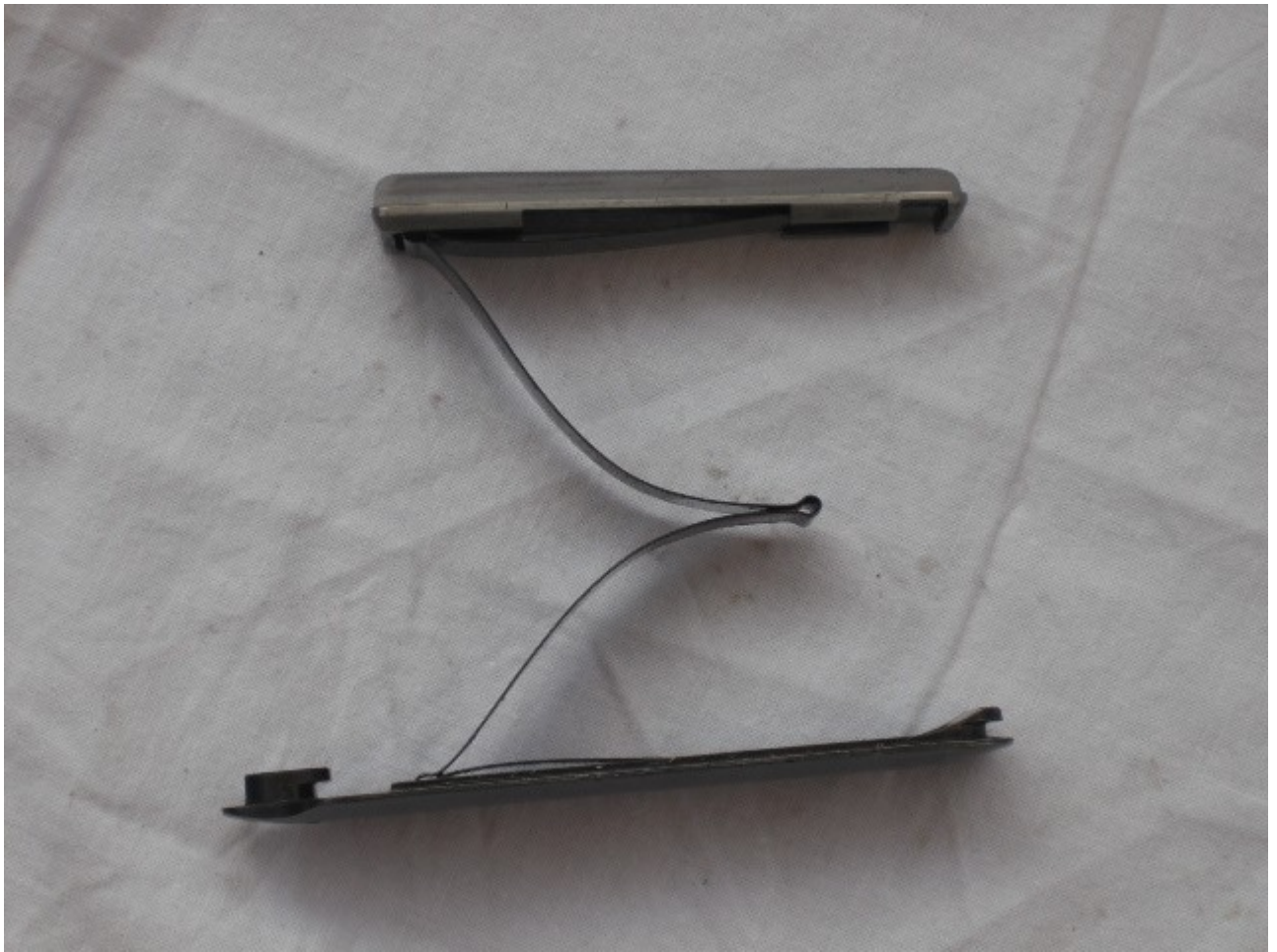
complesso soletta caricatore smontato con molla elevatrice a w
