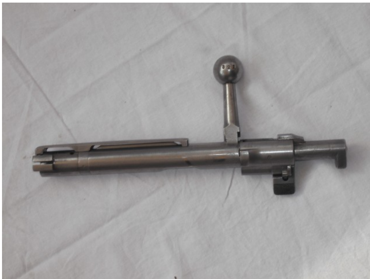
complesso otturatore come si presenta una volta sfilato dal castello, è assente il terzo tenone di sicurezza del modello m98 successivo
