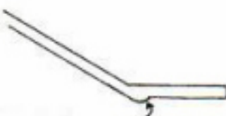
dopo il fire forming si rbalta all'interno del collo
