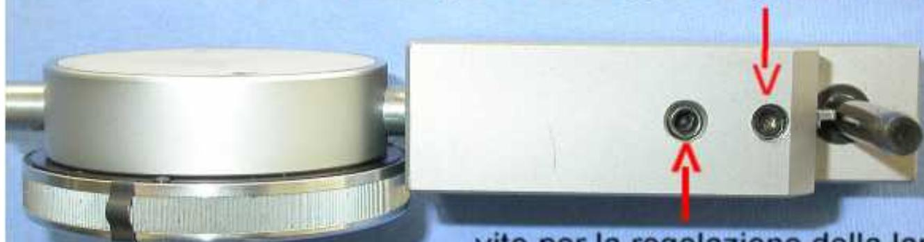
vite per la regolazione della lama
