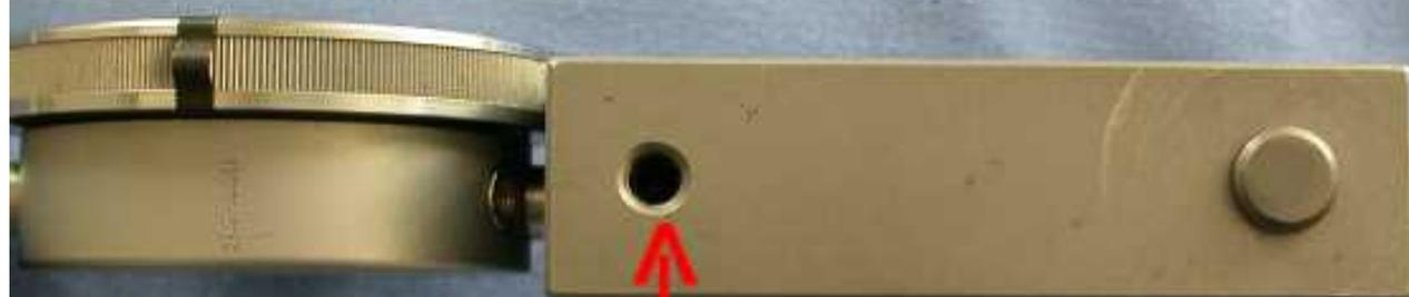
vite per il serraggio del comparatore
