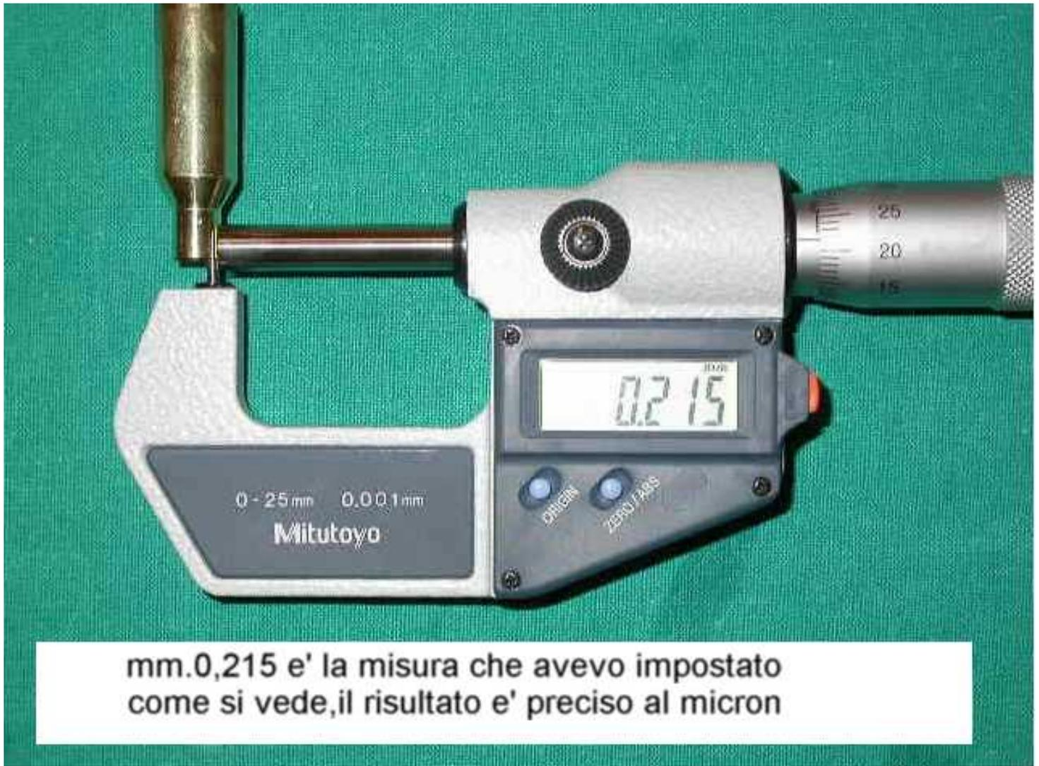
del loro spessore con tolleranze ridotte ad 1 micron ( a volte basta il solo calore della mano sul bossolo per falsare la misura del micron !) posso così sintetizzarli :
