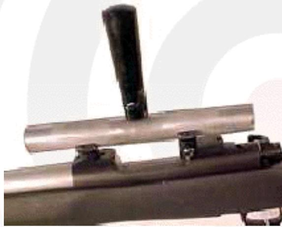
si mettono poi anche i semianelli superiori e si ruota il cilindro da dx a sn e viceversa , serrando gradatamente i semianelli superiori . Si ottiene così, una lappatura degli eventuali scalini e un serraggio più perfetto del tubo dell'ottica . Ultimamente sono apparsi in commercio attacchi che evitano tale operazione , ma sono limitati a quelli della SAKO e a quelli di JEWELL ,
