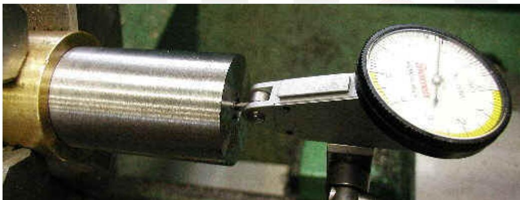
Questo strumento misura la centratura del foro della canna
