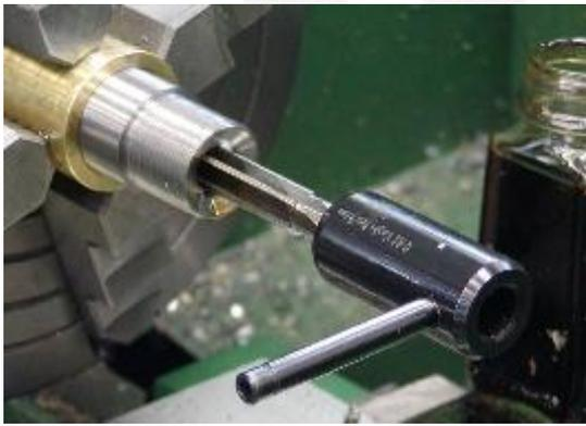
Ecco l'uso dell'alesatore per l'alesatura della camera di cartuccia.
