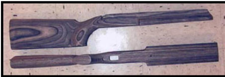
Non so se la preferenza a tali tipi di calci sia dovuta più a un fattore estetico che ad una reale prestazione , ma vedo che per problemi di ammortamento delle vibrazioni , sono piuttosto usati in carabine cal.22 LR . Per quanto riguarda le altre calciature , ve ne sono di fantastiche sia da caccia che da tiro , perlopiù in fiberglass
