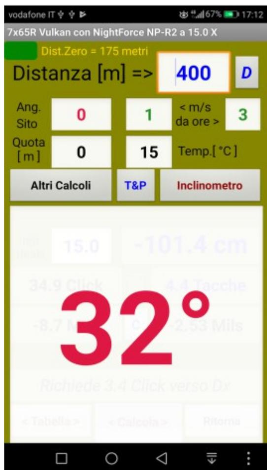
Toccare brevemente la grande cella bianca contenente il valore in gradi dell'inclinometro, per attivare la procedura.
