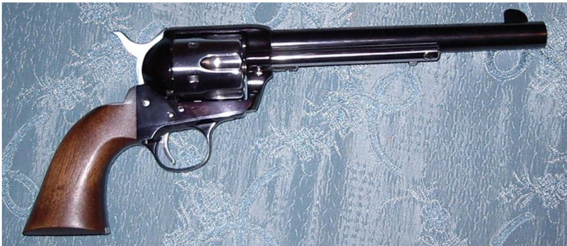
Questo revolver unisce la meccanica semplice delle Colt fino ad allora prodotte, rimasta praticamente immutata fin dai tempi della Walker, con un nuovo telaio chiuso con canna avvitata.
