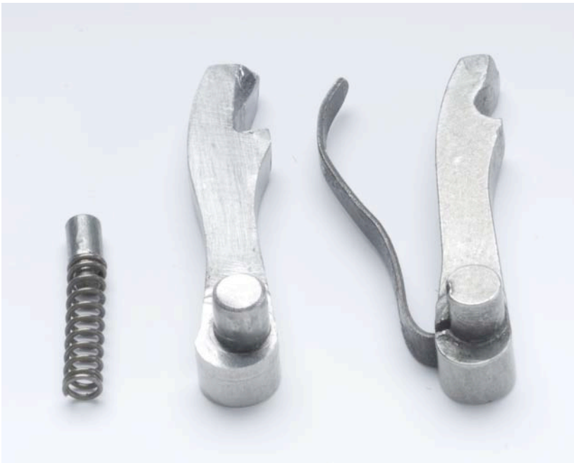
Foto 8 - Il bocciolo classico a destra e il bocciolo modificato con la sua molla a spirale.
