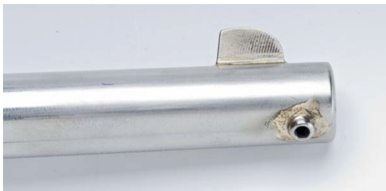
Foto 9 - particolare dei segni di saldatura a castolin.
