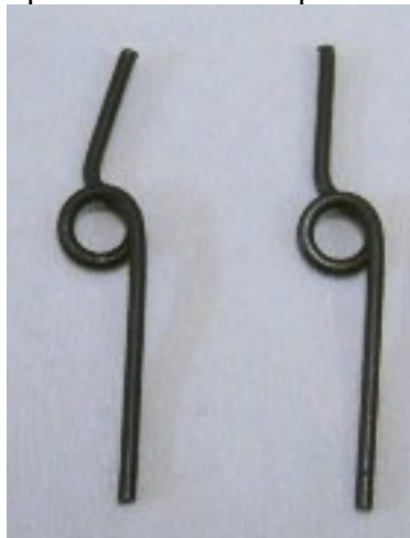
A sinistra la molla com'è in origine ed a destra dopo la suddetta modifica
