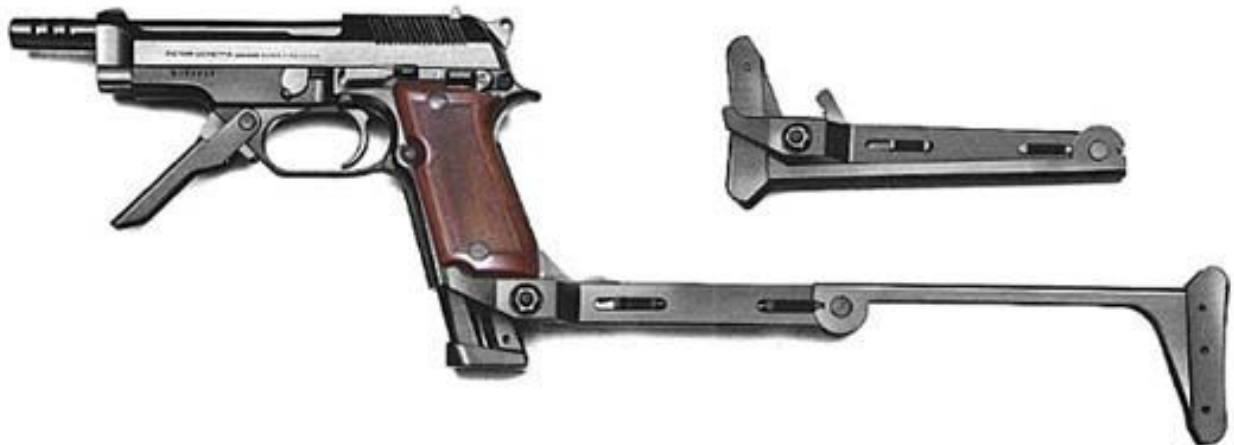
L’arma nella sua prima versione, con l’impugnatura anteriore aperta ed il calciolo-gruccia installato. Il selettore è posizionato sulla raffica controllata di tre colpi. Sopra al calciolo disteso ne viene mostrato uno richiuso.
