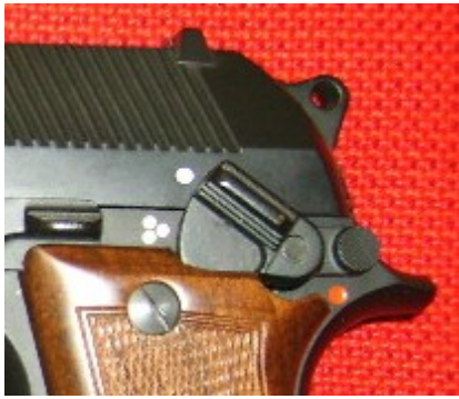
A sinistra: selettore posizionato su colpo singolo, cane abbattuto e sicura disinserita; A destra: selettore su raffica di tre colpi, cane armato e sicura inserita.
