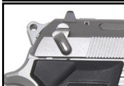
Sicura inserita e cane abbattuto, catena di scatto disconnessa, grilletto premibile ma non funzionante.
